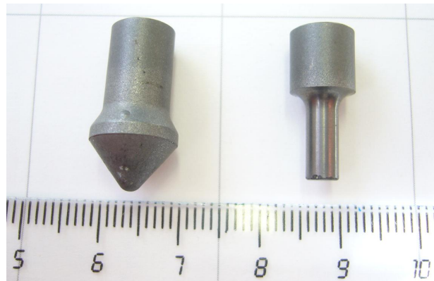
Abbildung 6.1: Konisches (links) und zylindrisches (rechts) Werkzeug
