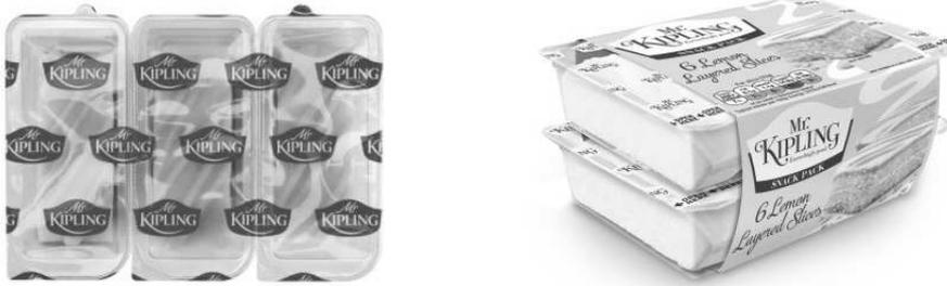
Bild 12: Aus dem Muttertray ausgestanzte 3er-Packung und ein Sleeve mit zwei Packungen
