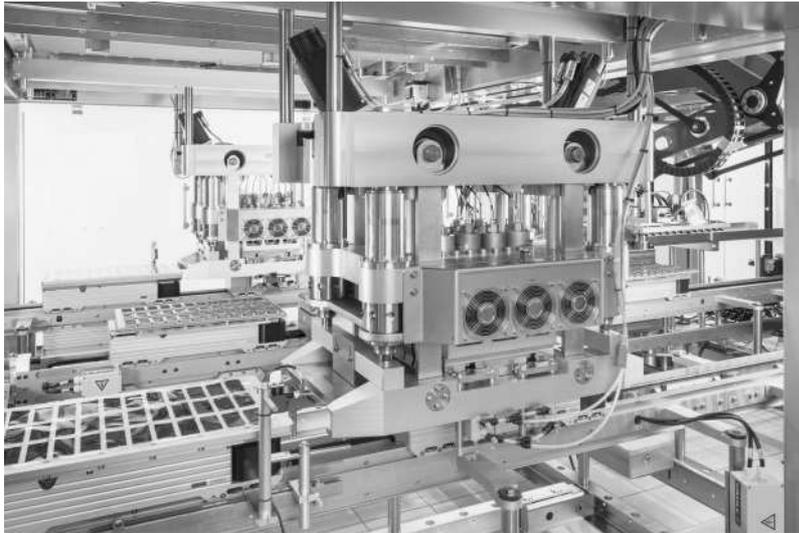
Bild 13: Ultraschall-Station, die die Deckelfolie auf das Muttertray siegelt
