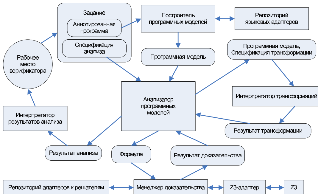
Рис. 1. Архитектура системы СПЕКТР
