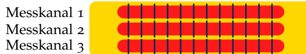
Abbildung 2.2: Horizontale, optische Messkanäle und senkrechte, linienförmige Sondenorte auf der Goldoberfläche eines SPR-Chips.
