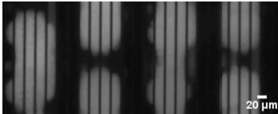
Abbildung 3.22: SPR-Signale (oben) und fluoreszenzmikroskopische Aufnahme (unten) nach der Hybridisierung auf hydrophob/hydrophil strukturiertem SPR-Chip analog zu Abbildungen 3.19 und 3.21.
