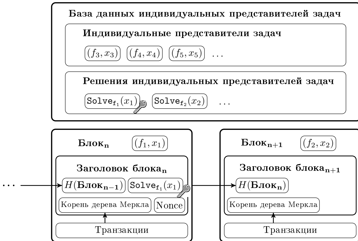
Рис. 2: Модель разработанного UPoWB-блокчейна. Рисунок иллюстрирует невозможность формирования n + 1 блока, так как ассоциированная с ним задача еще не прошла проверку администратором базы данных индивидуальных представителей полезных задач
