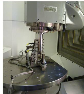
Automatische Werkzeug-Vermessung im Arbeitsraum mit Laser oder Taster
