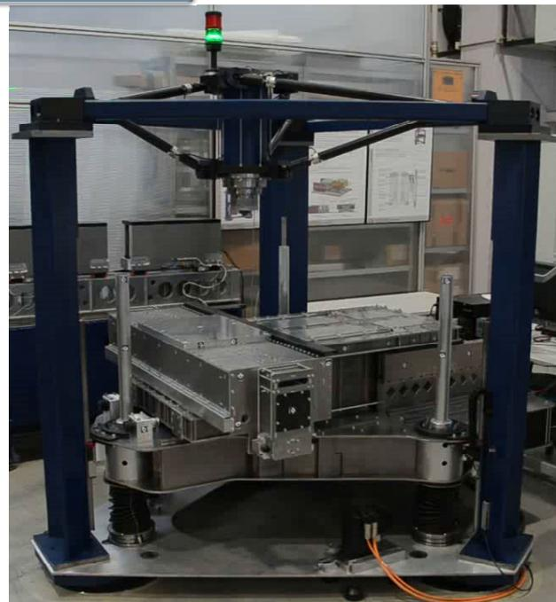
Thermografie und Nahbereichs-Photogrammetrie zur Erfassung von Temperatur- und Verlagerungsfeldern 4
