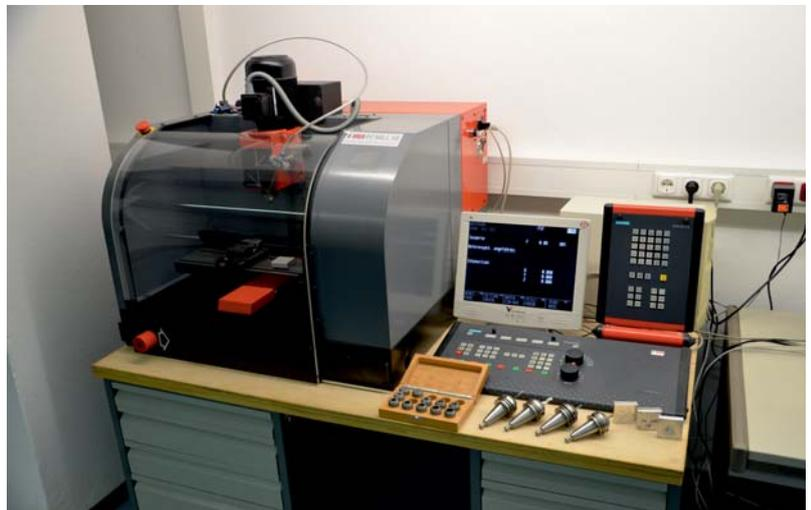
Modellfräsmaschine EMCO PC MILL 50 mit Steuerung und Werkzeugen
