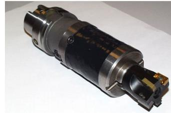
Fräswerkzeug mit Telemetrie
