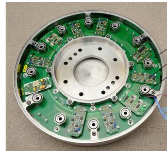
Pyrometer integriert in Schleifscheibe
