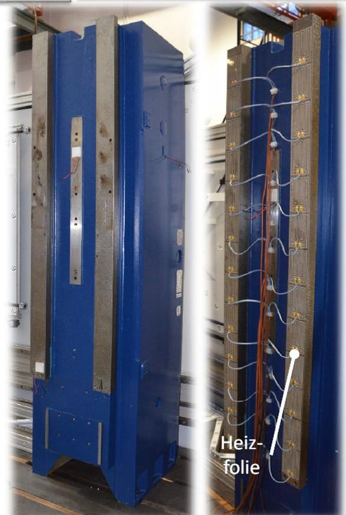
Thermografie und Nahbereichs-Photogrammetrie zur Erfassung von Temperatur- und Verlagerungsfeldern 16
