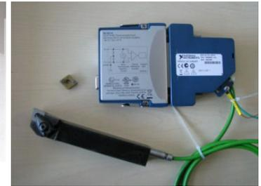
Drehwerkzeug mit Verstärker
