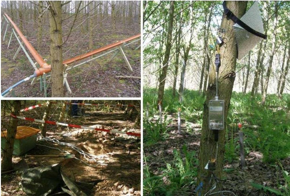
**Abb. 4.2.2-1: Versuchsaufbauten zur Erfassung von Komponenten des Standortwasserhaushalts**, links oben: Interzeptionsrinne zur Erfassung des Bestandesniederschlags (ohne Stammabfluss), links unten: Einbau von TDR-Sonden im Bodenprofil zur Erfassung der Bodenfeuchtedynamik, rechts: Saftflussmodul zur Abschätzung der Transpiration am Einzelbaum
