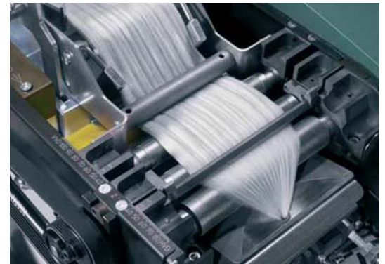
Streckwerk einer Spinnmaschine, deren Walzen durch einen Erkennungsalgorithmus während des laufenden Betriebes auf Verschleiß überwacht werden. (Foto: Fa. Rieter)
