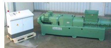
📷 Bio-extruder – optimal pulping ensures high output of biogas Photo: LEHMANN Maschinenbau GmbH
