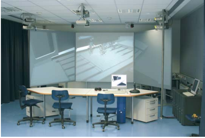
Abb. 1: VR-Installation zur Visualisierung von Anlagen und Prozessen
