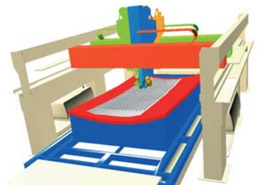
Abb. 3: Visualisierung einer Anlage zum Laserstrahlenschweißen großformatiger Bauteile
