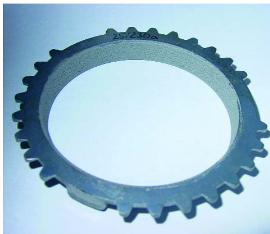
Bild 2: Synchronring mit neuartiger Reibschicht für PKW-Schaltgetriebe
