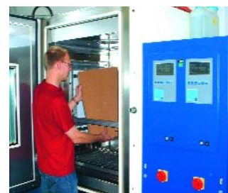
Abb. 2: Prüfung von Bauteilen im Doppelkammerklimaschrank (Bild: Pfriem)
