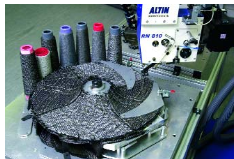
Mit den Nähgarnen für Composites vernähte textile Rotor-Preform
