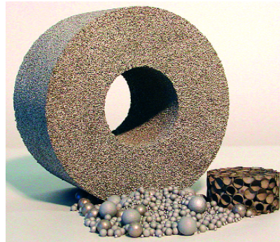
Bild 1: Metallische Hohlkugel- strukturen für die Schallabsorption
