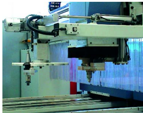
Abb. 2: CNC-Oberfräsmaschine SC20T der Firma MAKa mit Glättadapter
