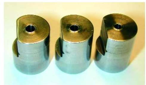
📷 Diamor®-beschichtete Tiefziehbuchsen für die Serienfertigung von Videolaufrädern (1,2 Mio. Teile / Jahr / Werkzeug)
