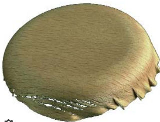
Abb. 1: umgeformtes Rotbuchenfurnier (0,6 mm dick), Form: Durchmesser 80 mm, Kantenradius 10 mm
