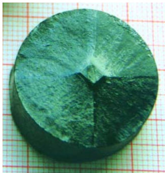
Der Hochtemperatur-Supraleiter YBaCuO als technischer Einkristall
