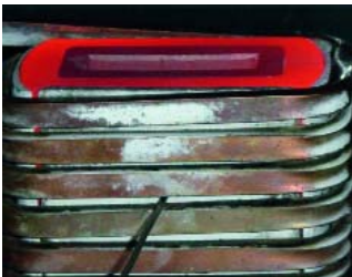
Bild 4: Heißpressmatrize aus Molybdändisilizid
