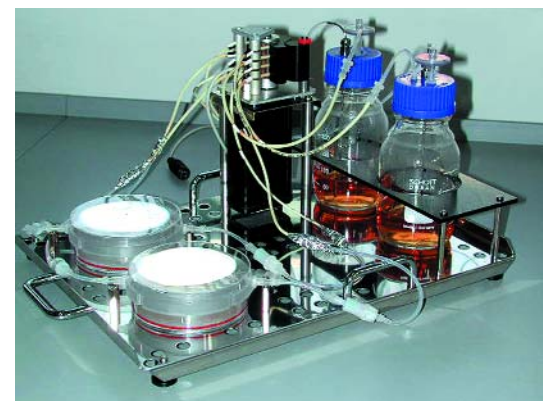
Abb. 4: PerCell-System zur Medienperfusion von Gewebekulturen (Prolatec, Radebeul)
