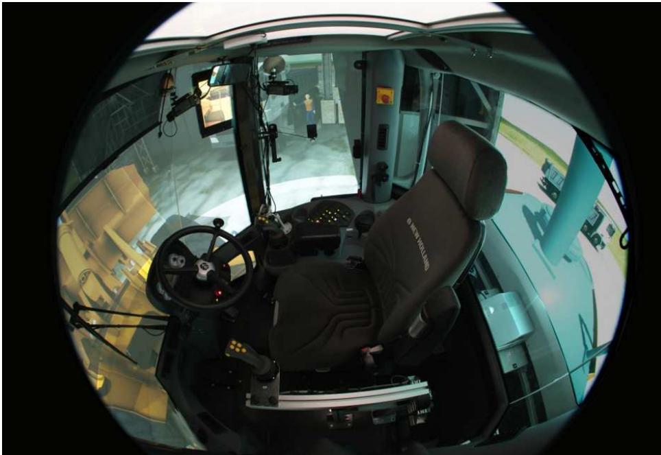
Abbildung 2.15: Fahrsimulator mit der Kabine einer mobilen Arbeitsmaschine
