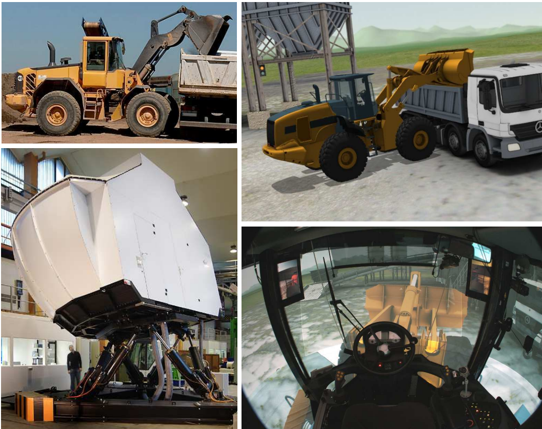
Abbildung 1.3: Interaktiver Simulator mit der Fahrsimulation eines Radladers
