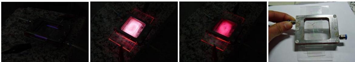
**Abbildung 69** Betrieb der Testkonstruktion; a) Entladung ohne Excimerbildung, b) und c) Excimer-Strahlung regt die Phosphorschicht zum Leuchten an, d) Implosion durch Unterdruck im Gasraum der Lampe
