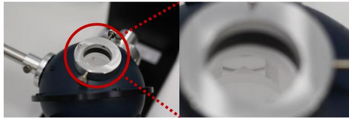
**Abbildung 11** Beispiel einer Ulbrichtkugel (links), innen (rechts) ausgekleidet mit einer hochreflektierenden Substanz
