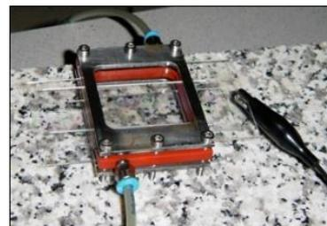
**Abbildung 68** Testrahmen für eine Gasentladungslampe (links) mit variiertem Schichtaufbau (rechts)
