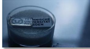
**Abbildung 55** Glassubstrat, beschichtet mit 6 Schichten  $\text{LaPO}_4\text{:Ce,Tb}$
