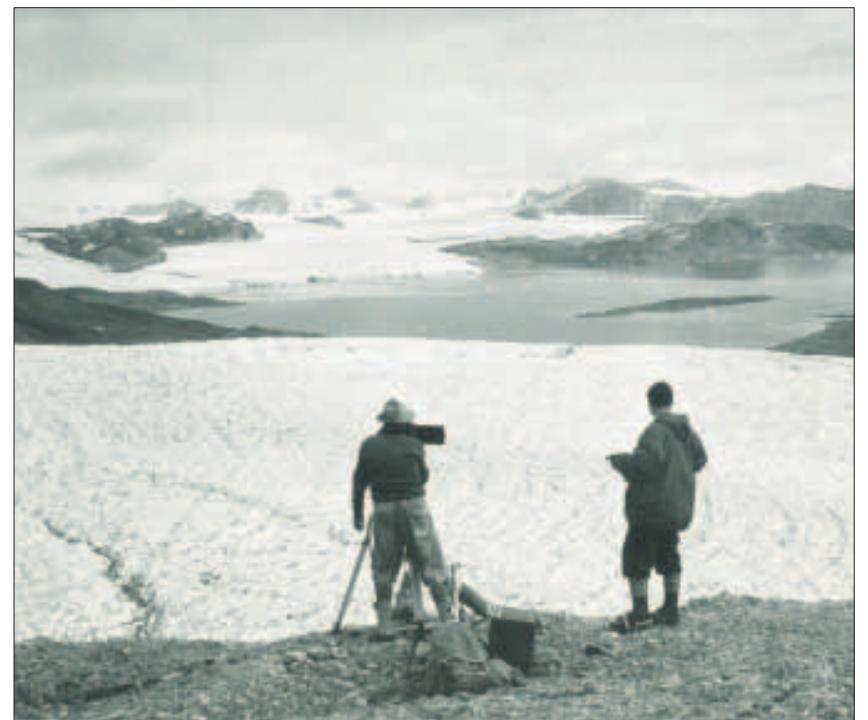
Der Gletscher wird mit dem Fototheodoliten aufgenommen.
