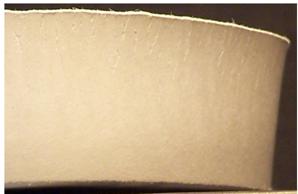
Abbildung 42: Vergleich der Faltenverteilung bei 100 und 1500 N Faltenhalterkraft
