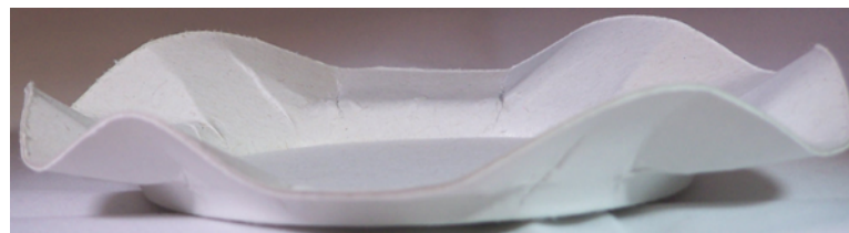
Abbildung 81: Teilweise gezogenes Kartonteil ohne Einsatz des Faltenhalters
