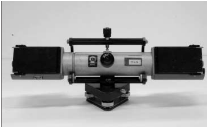
Stereomesskamera SMK 40 der Zeiss-Aerotopograph GmbH Jena (um 1935) aus der Ständigen Ausstellung der Kustodie der TU Dresden.
