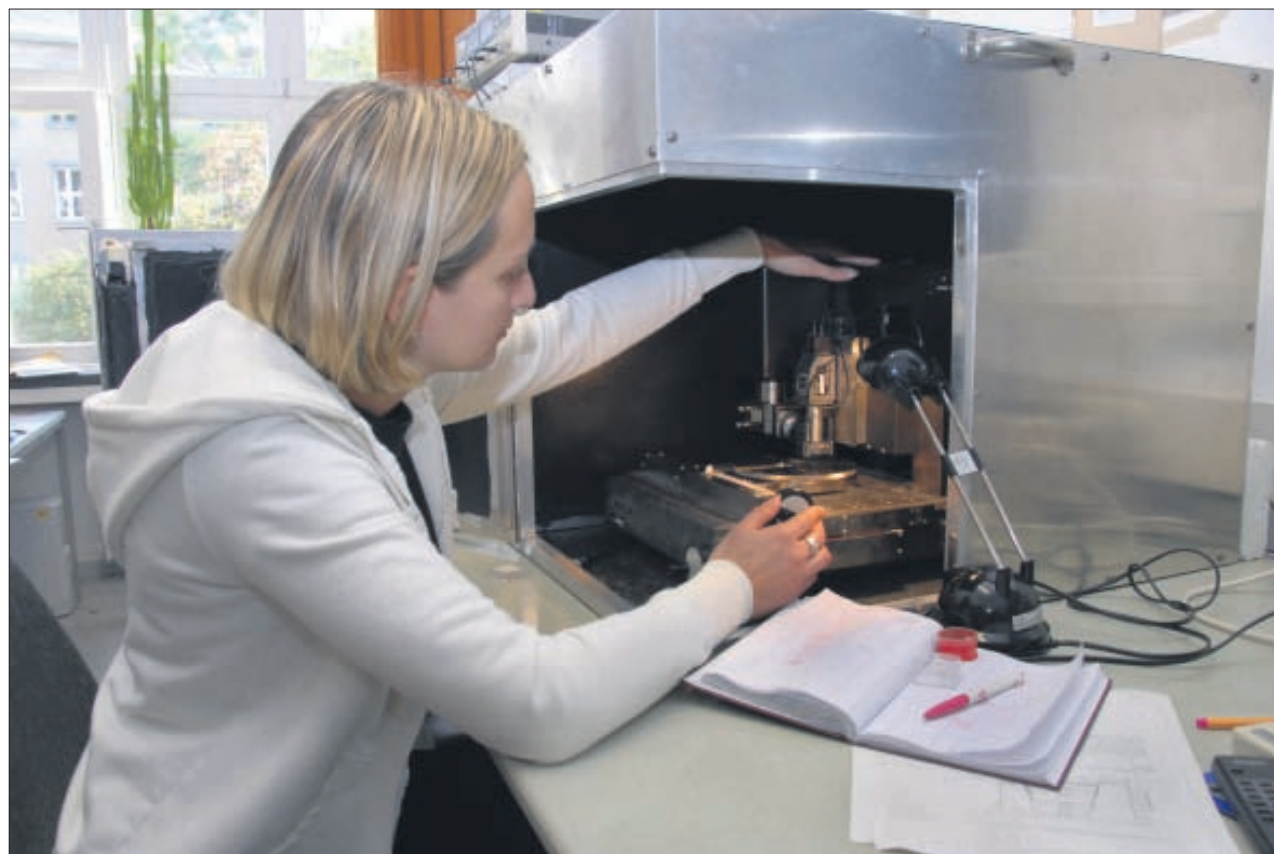
Irina Shakhverdova untersucht am Rasterkraftmikroskop die Härte von Werkstoffoberflächen. Die Wissenschaftlerin aus Sankt Petersburg gehört zur TUD-Nachwuchsforschungsgruppe Nanostrukturphysik um Jun.-Prof. Dirk Meyer. Fotos (2): UJ/Eckold
