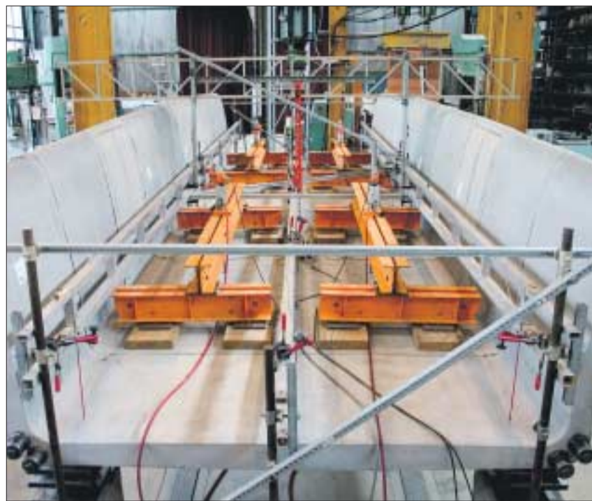
Blickt man auf den Brückenquerschnitt, erkennt man die Mess- und Belastungsinstrumente für den Versuch. Fotos (2): UVS
