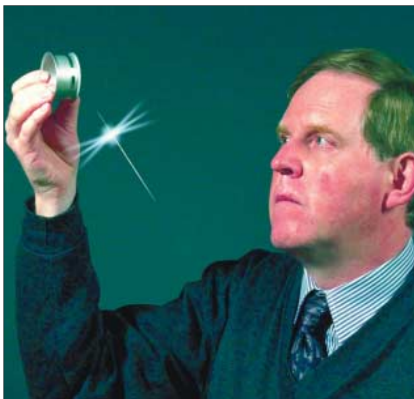
Der Bonddraht – ein äußerst dünner gezogener Draht aus einem gut leitfähigen Material wie Gold, Aluminium oder Kupfer – blitzt im Licht. Foto: Archiv Sender
