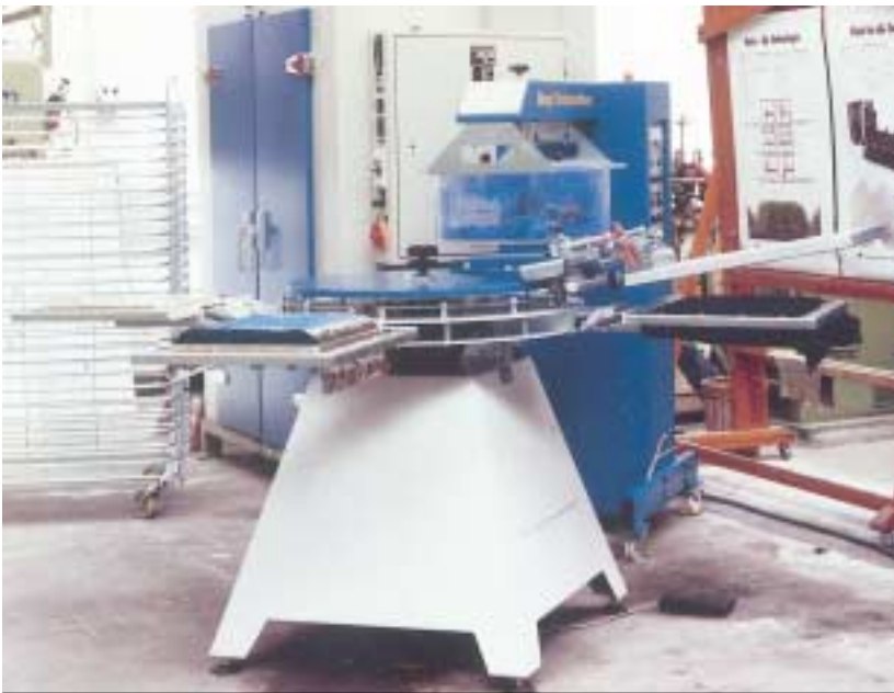
Auf die rotierenden Tische fallen durch das elektrostatische Feld die Textilfasern.
