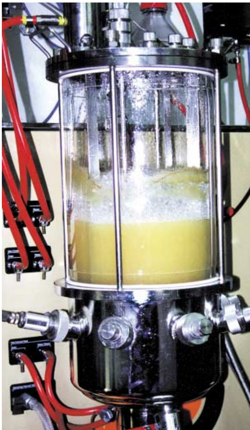
In dem Fermenter wird bei gleich bleibenden Temperaturen um 30 Grad Celsius die Peroxidase gezüchtet.
