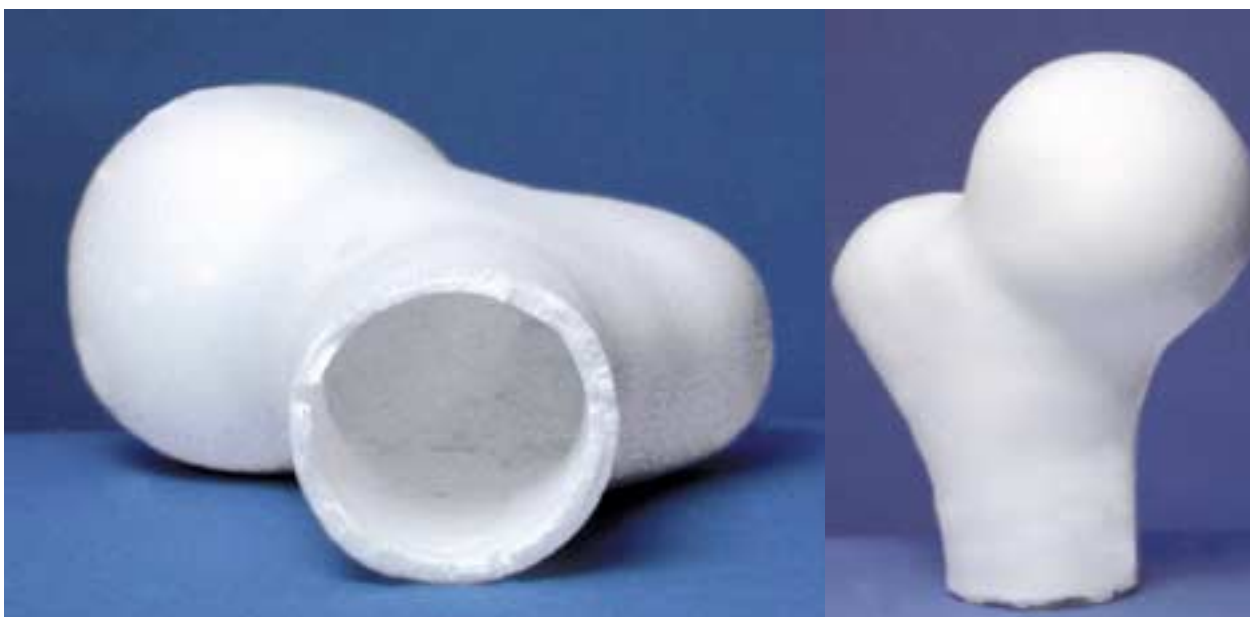
Aus der porösen Biokeramik lässt sich ein Hüftgelenkknochen formen, der künftig Menschen mit kaputten oder kranken Gelenken eingesetzt werden könnte.
