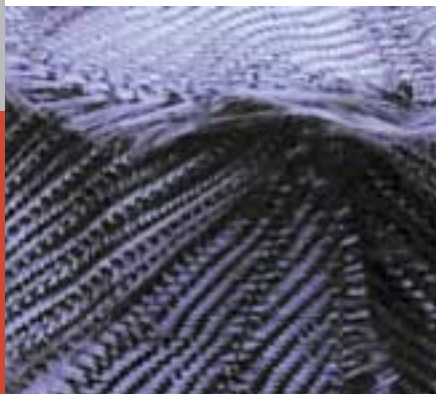
Eine spezielle Nähtechnik verstärkt den Rotor.
