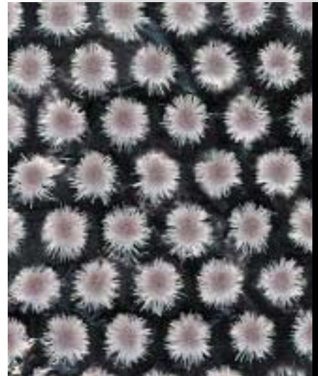
Zu Büscheln aufgerichtet kleben die Fasern auf dem Dämmstoffträger.
