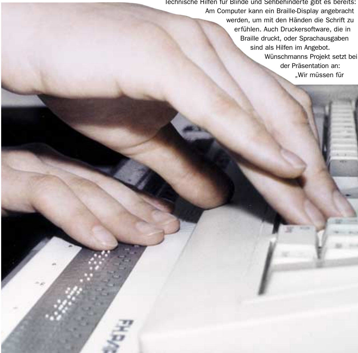
Die Hardware ist kein Problem für Blinde und Sehbehinderte: Auf einem zusätzlichen Braille-Display „lesen“ sie die Texte am Computer.
