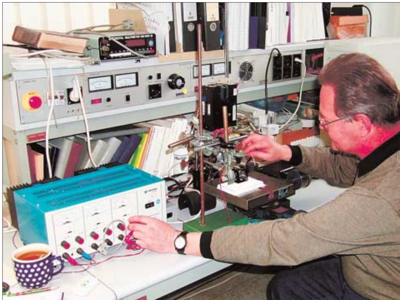
Dieter Baumert, wissenschaftlicher Mitarbeiter Physik des IMT, beim Laboraufbau zur Messung der Füllstände in Mikrotiterplatten von Pipettierrobotern mit Ultraschallsensoren. Fotos (2): Universitätsmarketing / Ackermann, Thierfelder
