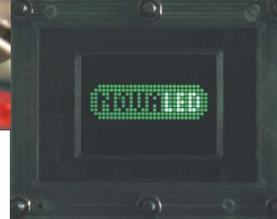
Abb. 3 (links): Passiv-Matrix OLED Display mit dotierten Transportschichten
