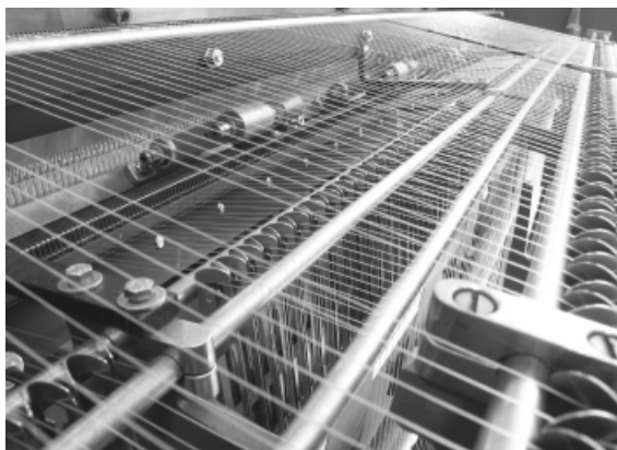
Webstuhl zur Herstellung von Glasfaser- Bewehrungsstoffen
