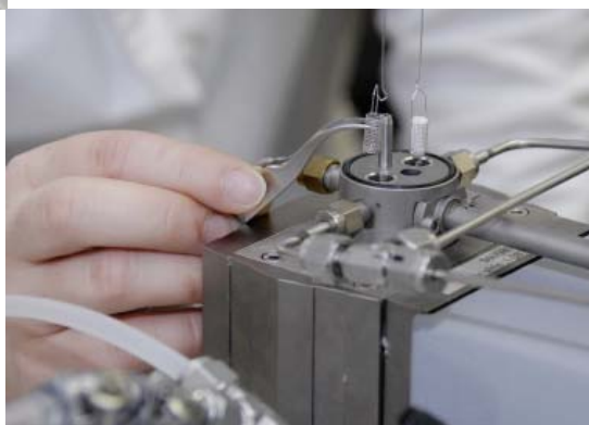
Promotionsstudentin Nicole Klein vom Institut für Anorganische Chemie bestimmt am Kalorimeter, wieviel Butan poröse Materialien speichern können. Fotos: UJ/Eckold
