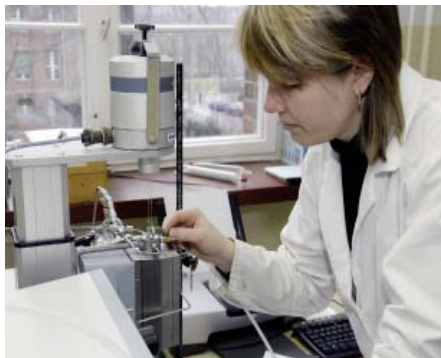
Promotionsstudentin Nicole Klein vom Institut für Anorganische Chemie bestimmt am Kalorimeter, wieviel Butan poröse Materialien speichern können. Fotos: UJ/Eckold
