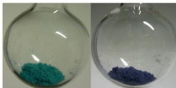
Abbildung 4.88.: Farbänderung von DUT-54 durch Entfernen des Lösungsmittels aus der Verbindung **33**. *Links*: unaktivierte Probe; *Rechts*: aktivierte Probe.
