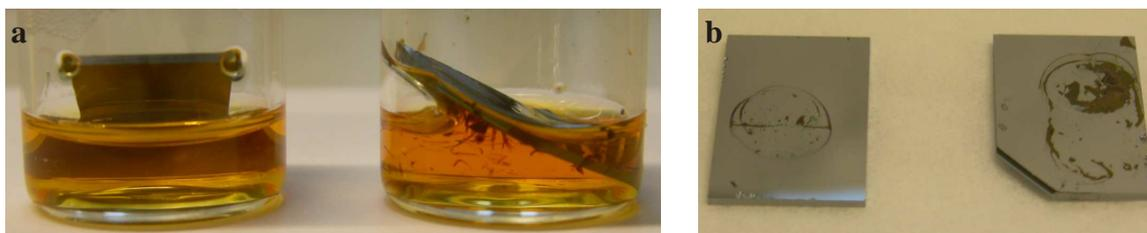
**Abbildung 107:** Bilder von Blend-Filmen ohne (links) und mit (rechts) **P3HT-*b*-AzC2**-Zusatz nach der thermischen Vernetzung (vier Stunden, 150 °C) a) in Chloroform-Lösung und b) nach dem Löse-Prozess
