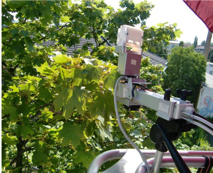
Abbildung 3.4: Messküvette mit Lichtaufsatz des Steady-State-Porometers bei der Messung an Spitz-Ahorn (Sommer 2009) auf der Lilienthalstraße.
