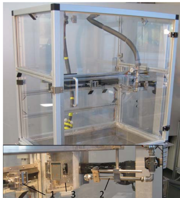
Abbildung 5-15: SRVST mit Detailaufnahme von Probenhalterung (1), Düsenstock (2) und optischer Detektionseinheit (3)
