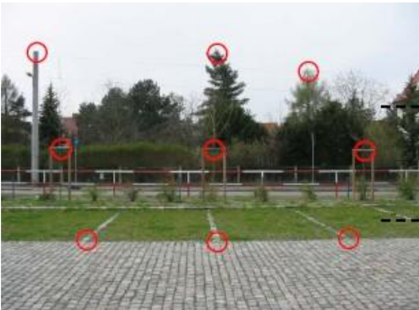
Bild 3-5: Kalibrierung der Szeneriekamera anhand markanter Umgebungspunkte (WEICHERT 2005)
