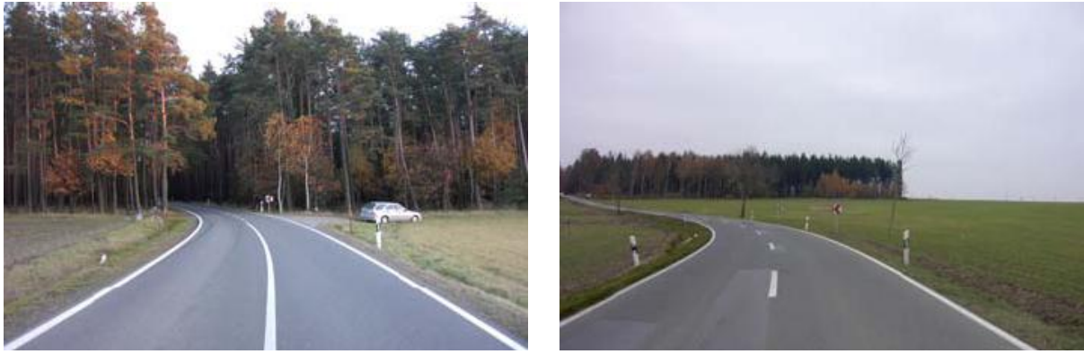
Bild 2-9: Kurven mit und ohne Beschränkung der Sichtweite
