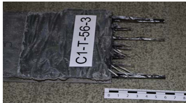
(b) Versagen des inneren Verbundes durch Faserauszug infolge Schädigung
