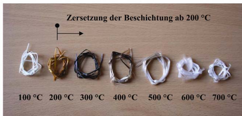
Bild 1: Verfärbung der beschichteten AR-Glasfilamentgarne infolge der steigenden Temperatur
