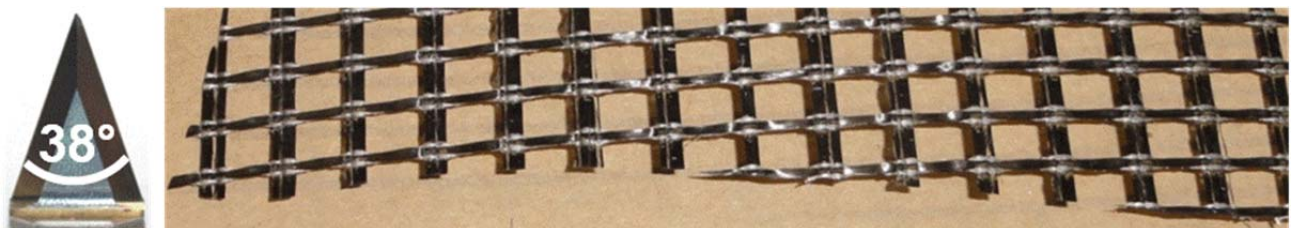
Abbildung 2: Messer (links) und damit ausgeführte Schnittkanten an einer Carbonfilamentgarn-Gitterstruktur (rechts).
