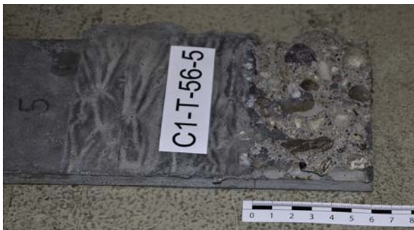
(a) Verbundversagen im Altbeton
