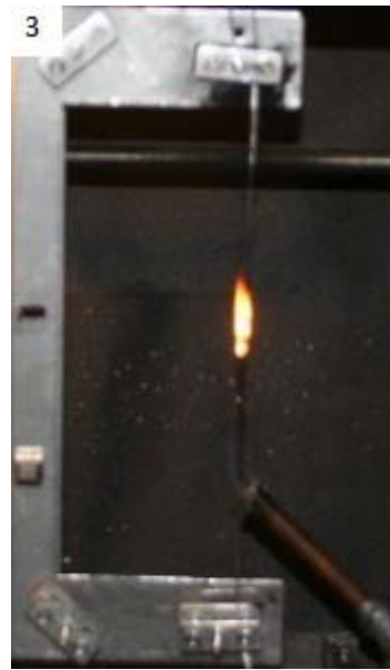
(b) eingespannte Garnprobe im Flammversuch
