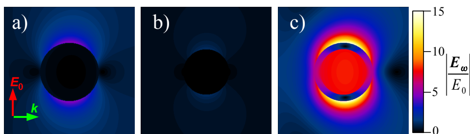
Abb. 2.21: Darstellung des Betrages der fundamentalen elektrischen Feldstärke \mathbf{E}_\omega bei einem Goldpartikel von 90 nm Durchmesser (a), einem \text{BaTiO}_3 -Partikel ( n=2,4 ) von 70 nm Durchmesser (b) und einem Core-Shell-Nanopartikel mit einem 70 nm großen Kern aus \text{BaTiO}_3 und einer 10 nm dicken Goldschale (c). Die Partikel befinden sich in einem Medium mit n = 1 und werden von einer ebenen Welle (800 nm) angeregt. Deutlich zu sehen ist an diesem Beispiel die Feldüberhöhung innerhalb des \text{BaTiO}_3 -Kerns, welche viel höhere Feldstärken als innerhalb des reinen \text{BaTiO}_3 -Partikels erzeugt.
