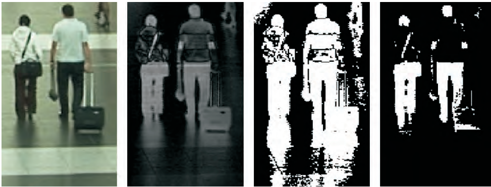
Abbildung 3.2: Extrahieren der Vordergrundinformationen aus der Differenz zwischen dem aktuellen Bild und bekannten Hintergrundinformationen. In der Reihenfolge (v.l.n.r): Original, invertierter Vordergrund in Graustufen, binarisierter Vordergrund mit niedrigem Schwellenwert sowie binarisierter Vordergrund mit hohem Schwellenwert [162]
