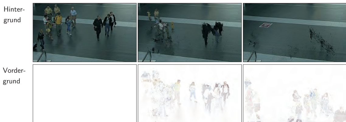
Abbildung 3.1: Erstellung der Hintergrundinformationen durch adaptive Anpassung der zeitlich unveränderlichen Bildbereiche. Die Subtraktion der Hintergrundinformationen vom aktuellen Bild führt zur Segmentierung des Bildvordergrundes. Im Zeitverlauf nimmt die Abgrenzung der beiden Bereiche zu (v.l.n.r).
