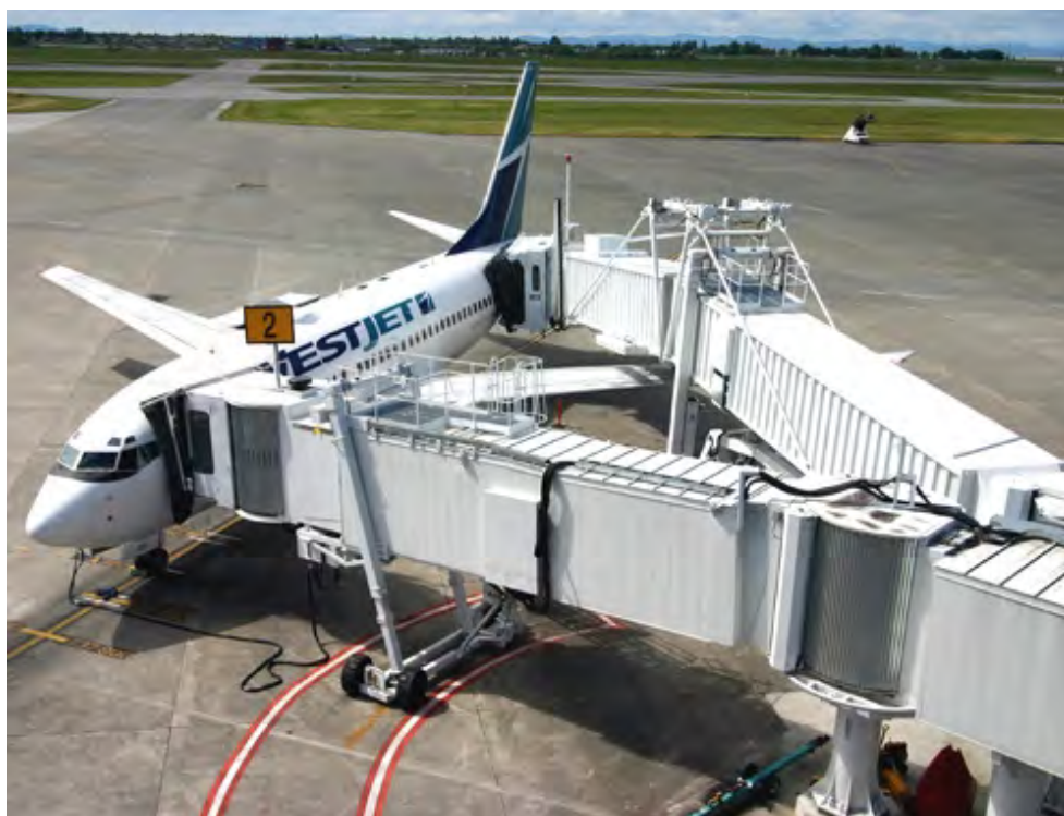
Abbildung 4.15: Over-the-Wing Brücke an einer Boeing B737 am Vancouver International Airport [267].
