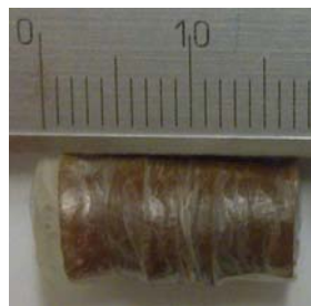
Abbildung 7.10 Phantom für die SR \mu CT-Anlage, bestehend aus sechs PUR-Ferrofluid-Gelen.
