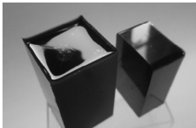
Abbildung 7.4 Polyurethangel mit darin suspendiertem Ferrofluid.
