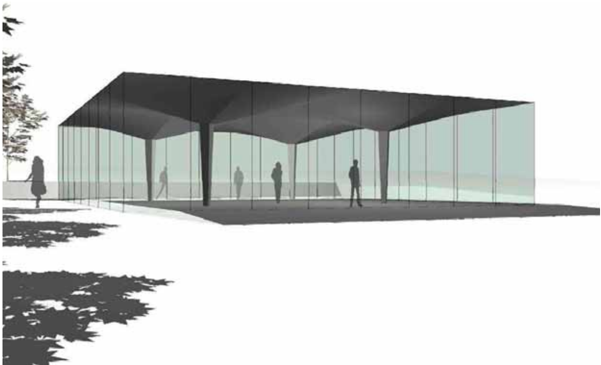
Bild 1: Computeranimation des geplanten Ausstellungspavillons mit einer Dachkonstruktion aus Textilbeton (bauko2, RWTH Aachen [1]).
