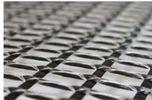
(b) Biaxialstruktur aus Carbon
