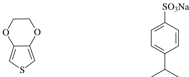
Abb.3.2-1: Chemische Struktur des Monomers 3,4-Ethylendioxythiophen (EDOT) (links) und des verwendeten anionischen Tensids Natriumcumolsulfonat (rechts)
