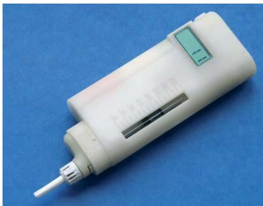
Abb. 2: Funktionsmuster des automatischen Injektionsgerätes in der Größe eines Mobiltelefons mit eingelegter Ampulle und aufgesteckter Pennadel (mit Schutzkappe)
