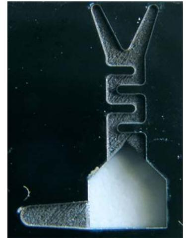
Abb. 1: Ausschnitt eines Glas-Silizium-Verbundsystems für die prädiktive Substanztestung an Zellkulturen mit optischer Detektion
