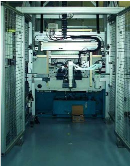
Automatisierung einer Profilwalzmaschine (Fotos: EKF AUTOMATION GmbH)
