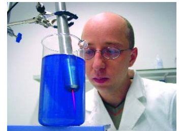
📷 Sensor mit Lichtstrahl Das Aello-Prinzip: Der Sensor sendet Licht in die auszumessende Substanz. Anhand des an den Partikeln reflektierten Lichtes kann über ein statistisches Verfahren eine mittlere Partikelgröße bestimmt werden.
