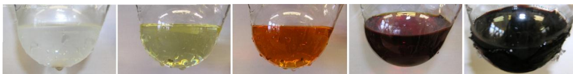
Abbildung 4.39 Fotos der Synthese von OFC-1A in Lösung, aufgenommen direkt nach der Zugabe verschiedener Mengen \text{SiCl}_4 (in Bezug auf 0.2 g 1,4-Diacetylbenzol in 60 ml Ethanol/Toluol (5:1), vom linken zum rechten Foto: 0 ml, 8 ml, 10 ml, 12 ml (80 Äq.), 12 ml nach 30 min).
