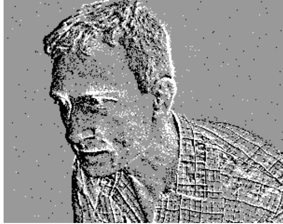
Abbildung IV.7: Darstellung einer Innenraum-Szene mittels des Änderungsdetektors bei zirka 200lx und minimal detektierbaren Änderungen der Bestrahlungsstärke von \pm 10\%
