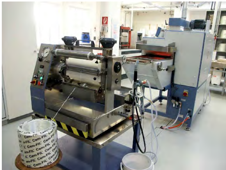
Abb. 4.3: Beschichtungsanlage des IPF; Foulard mit Trocknungsstrecke
