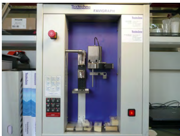
Abb. 4.8: FAVIGRAPH (TEXTTECHNO); Zugprüfgerät für Filamente
