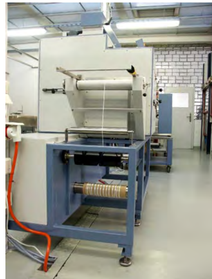
Abb. 4.4: Beschichtungsanlage des IPF; Aufwicklung des beschichteten Rovings
