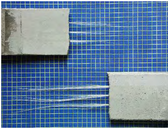
Abb. D.1: Betonprobekörper nach dem Zugversuch, geschichtetes IPF ARG (Bsp.: IPF ARG 1), 28 d, Standardlagerung
