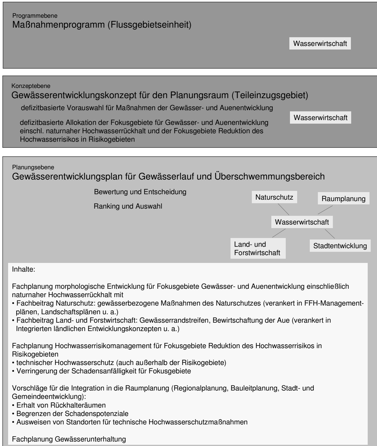
Abb. 27: Schematische Darstellung einer Möglichkeit der integrierten Maßnahmenplanung am Gewässerlauf und im Überschwemmungsbereich (inkl. Risikogebiet)
