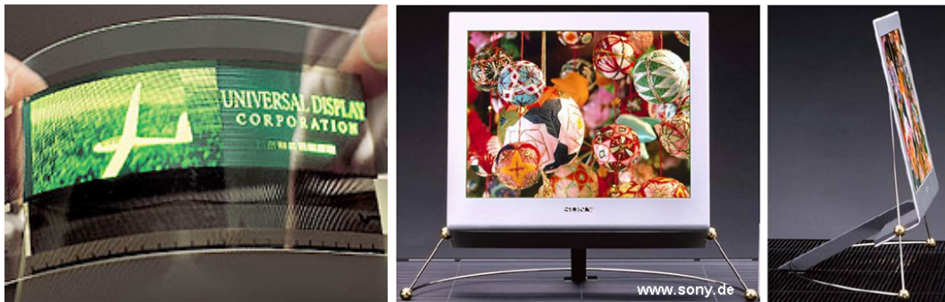
Abbildung 1.2: Monochromes flexibles OLED-Display (li.) und Prototyp eines vollfarbigen OLED-Displays (re.).
