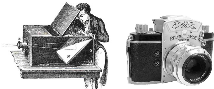
Abbildung 3.1: Camera obscura [ www.foto-faq.de ] und Exa Rheintal, die erste (1952) in Großserie produzierte SLR-Kamera [ www.kamera-sammelsurium.de ]
