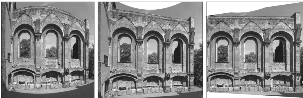
Abbildung 3.8: Panoramaausschnitt ca. 90^\circ , Tangentialbild, ebene Entzerrung (v.l.n.r.)
