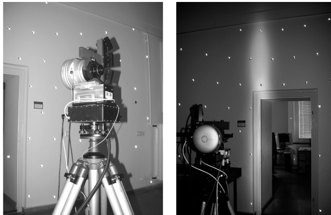
Abbildung 5.2: Panoramakamera im Kalibrierraum (links) und Streifenlichtbeleuchtung (rechts)
