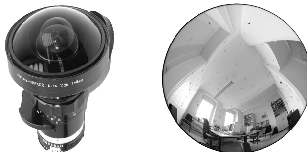
Abbildung 3.16: Fisheye-Objektiv Nikkor 8 mm (links) und Fisheye-Bild (rechts)
