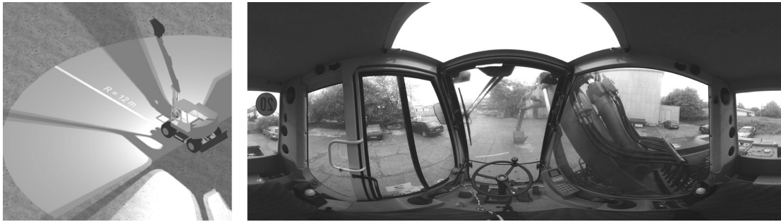
Abbildung 3.10: Prinzip der Schattenwurfmethode und Panorama aus einem Baggerführerhaus
