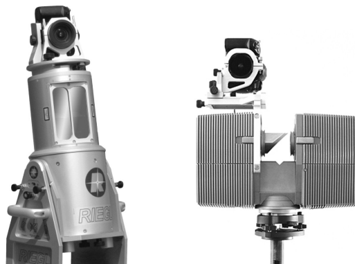
Abbildung 3.32: Hardware-Kombinationen aus Laserscanner und Kamera: Riegl [Riegl, 2007] (links), FARO [Faro, 2005] (rechts)
