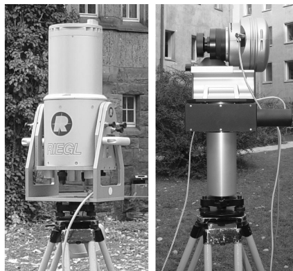
Abbildung 5.8: Laserscanner und Panoramakamera zur parallaxenfreien Aufnahme nacheinander auf gleichem Stativ
