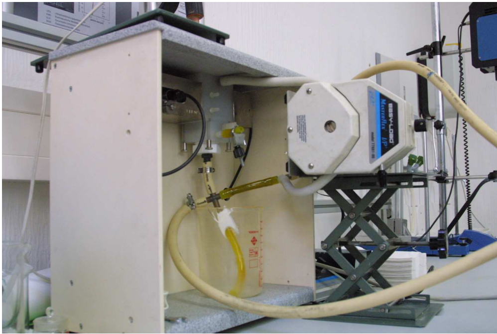
Abbildung 4.11: Das Ultraschallspektrometer DT 1200 mit zusätzlichen Aufbauten (Pumpe, Wärmeübertrager). Vergleiche Abb. 4.12 für eine schematische Darstellung des abgebildeten Aufbaus.
