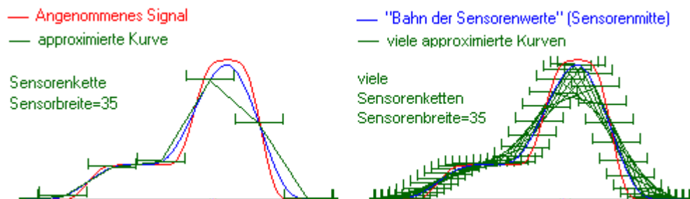
Abbildung 12: Durch Geraden approximierter Kurvenverlauf der Sensorenbahn (einfache und mehrfache Abtastung des angenommenen Signals)
