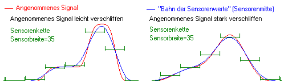
Abbildung 11: Beispiele von Bewegungsbahnen von "Sensorenketten" bei Abtastung verschieden verschliffener Ausgangssignale
