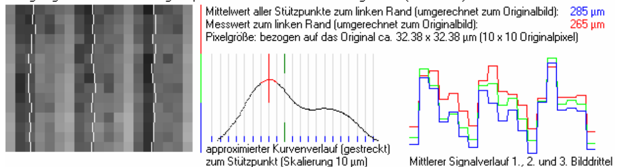
Abbildung 15: Beispiel zur Bewertung komplexer Signale (Original links oben) bei rechnerischer Vergrößerung des Originals unter Anwendung des beschriebenen Verfahrens
