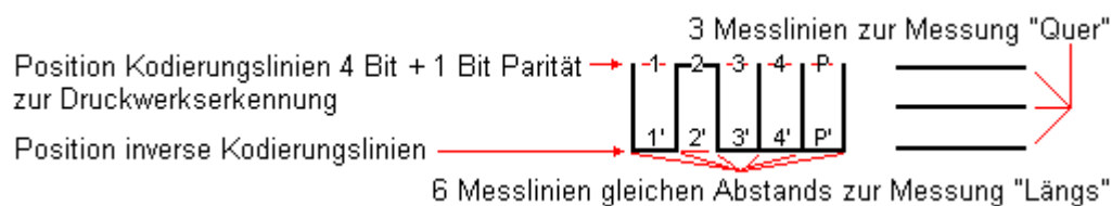
Abbildung 23: Aufbau der inneren Messelementstrukturen
