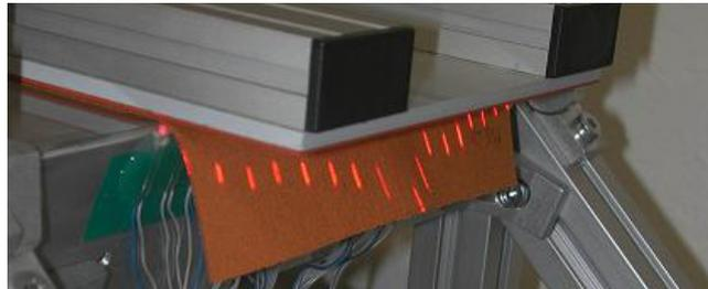
Abb. 6.6: Wirkung der Lichtschranken während der Prüfung
