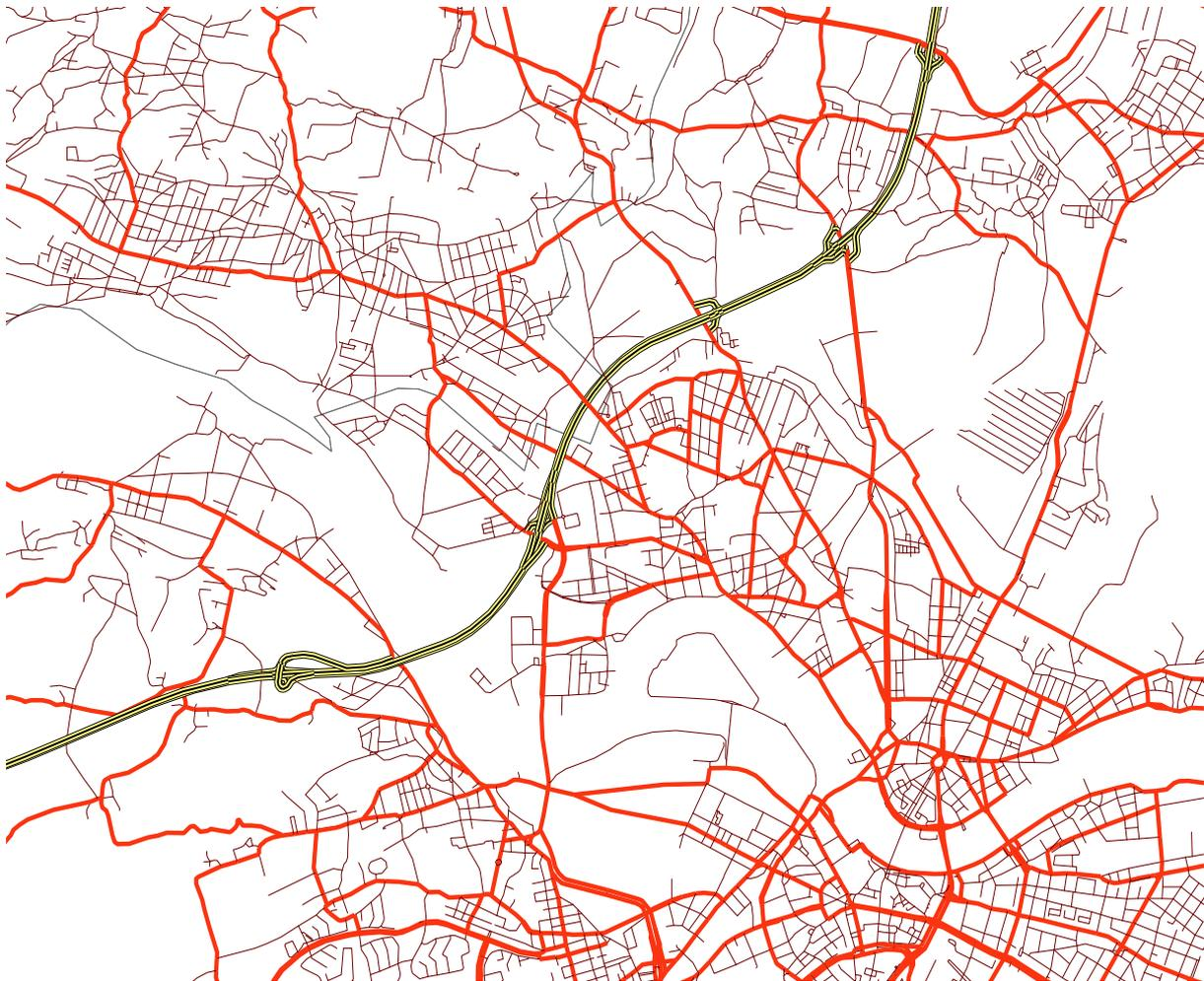
Abbildung 14: Einteilung des Straßennetzes in die Kategorien Bundesautobahn, Haupt- und Nebennetz, Quelle: Emissionskataster Verkehr
