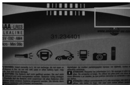
Abbildung 14: Bedruckte Blisterverpackung - Beobachtungsbereich des Bildverarbeitungssystems, rechts oben markierter Bereich
