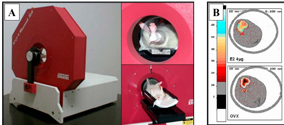
Abb. 3.5: In vivo Messung der Knochendichte in der Tibia von Ratten (A). Auszuwertende Querschnittsbilder der vermessenen Schnittebenen (B).
